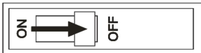
2.2. REMOVA O INTERRUPTOR JÁ INSTALADO. COM O CABEAMENTO DEFINIDO FASE, NEUTRO, TERRA E CARGA, FAÇA A LIGAÇÃO DO INTERRUPTOR INTELIGENTE JFL-SS1.
